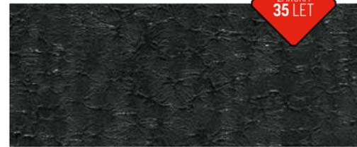
Silný (35 µm) organický povlak se zajímavou krystalickou povrchovou strukturou, připomínající silně nanesenou barvu. Jádro je ocelové s nanesenou slitinou zinku a hořčiku, což zajišťuje zvýšenou ochranu před korozi. Výsledkem je významný růst odolnosti proti bílé a červené korozi v prostředí RC3.
