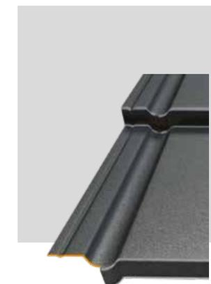
EASY LINK autorské řešení, díky kterému se listy k sobě hodí jak nikdy dříve. V zájmu eliminace efektu vytlačování překrývajících se plechů v místě spojení třech listů, v modulových taškách IZI bylo použito vyřezání rohu dolního prolisu.
