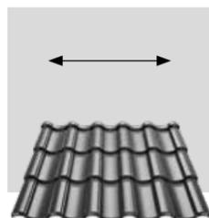
Provádění montáže libovolným směrem. Konstrukce klasických střešních krytin STIGMA umožňuje provádět montáž libovolným směrem (zleva nebo zprava).
