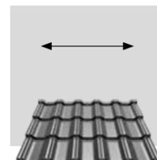
Provádění montáže libovolným směrem. Konstrukce klasických střešních krytin GAMMA umožňuje provádět montáž libovolným směrem (zleva nebo zprava).
