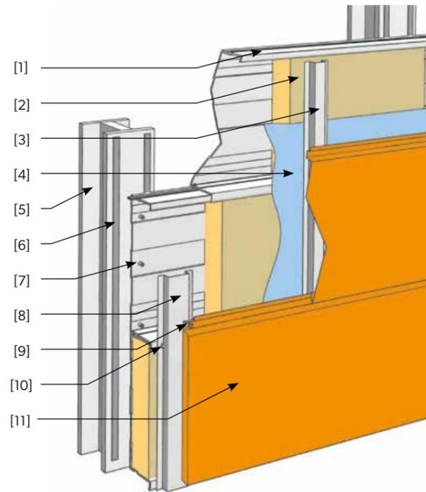
Předností zavěšených fasád zabudovaných s použitím fasádních kazet SKRIN je rychlá a málo komplikovaná montáž. Mohou být použité na libovolné stěně, protože jsou zavěšeny na podkonstrukci, kterou stanoví ocelový rošt vyrobený ze základních profilů P03 20/90.
