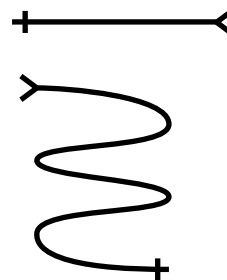
Predlžovacie káble a rozvody
